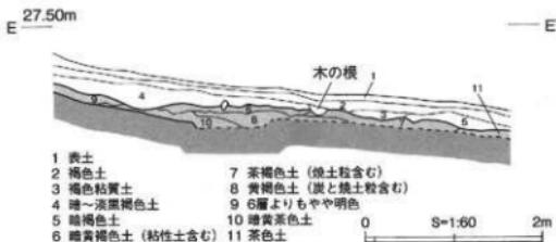
第211図 SB-29・30 土層断面図
