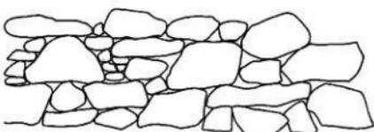
布（目）積み崩し（野面石を用いた例）
