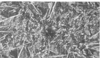
photo.9 楕型鉄冶津・鉄塊系遺物の顕微鏡組織
