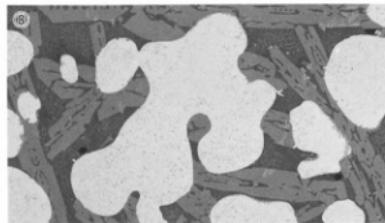
photo.8 流動津・楕形鍛冶津の顯微鏡組織
