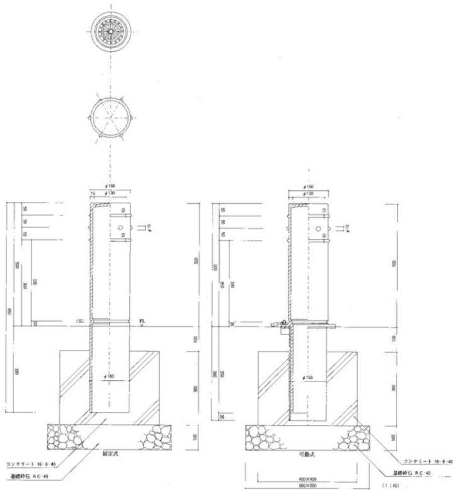
第24図 車止め (固定式と可動式) 設計図
