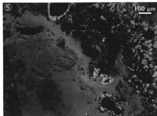
Photo. 5 羽口・椀形鍛冶滓の顕微鏡組織
