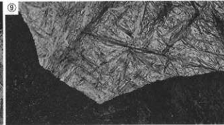
Photo.8 鉄塊系遺物の顕微鏡組織
