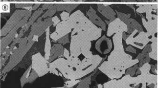
Photo.9 砂鉄焼結塊と製錬滓の顕微鏡組織
