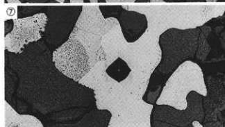
Photo.10 鉄滓の顕微鏡組織
