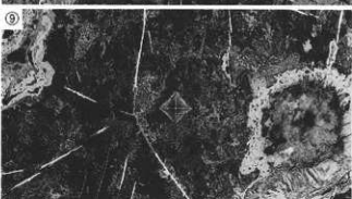
Photo.7 鉄塊系遺物の顕微鏡組織
