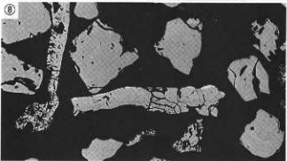
Photo.23 砂鉄・鍛造剥片混合物の顕微鏡組織
