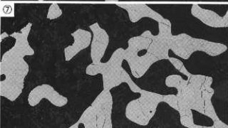
Photo.5 含鉄鉄滓の顕微鏡組織
