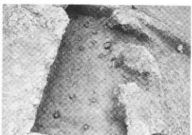
熱残留磁気測定資料採取状況
