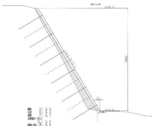
图47 北侧工区标准断面图 ( $S=1/200$ )
