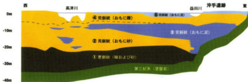
第3図 益田平野の地下地質断面図
