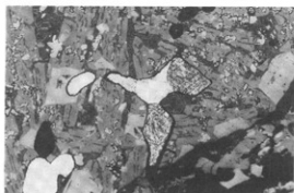
写真7-2 資料No.21号炉鉄塊ナチュラル腐食 (×100)
