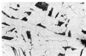
×100 鉄塊系遺物金属組織写真 (資料 No. 12-1)
