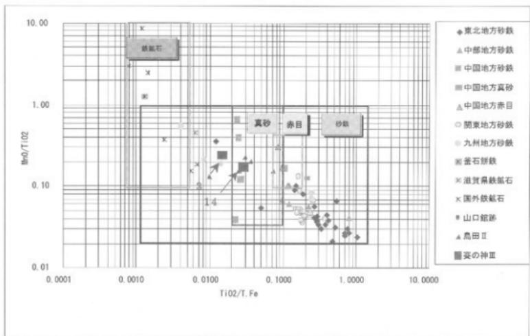
第53図 砂鉄と鉄鉱石原料の酸化チタン量 ( $TiO_2$ ) と酸化マンガン ( $MnO$ )
