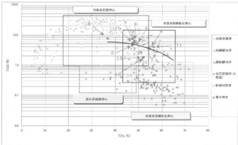
第49図 出土鉄滓の全鉄量(T.Fe)と二酸化チタン量(TiO<sub>2</sub>)の分布図
