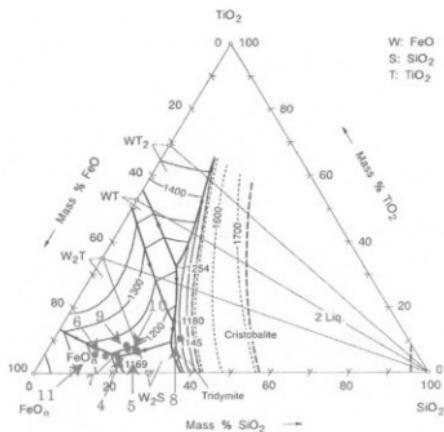
第47図 FeOn-SiO<sub>2</sub>-TiO<sub>2</sub> 系鉄滓の平衡状態図FeOn-Fe<sub>2</sub>O<sub>3</sub>-SiO<sub>2</sub> 系状態図
