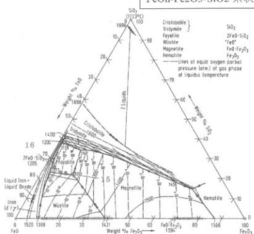
第48図 FeOn-Fe<sub>2</sub>O<sub>3</sub>-SiO<sub>2</sub> 系鉄滓の平衡状態図
