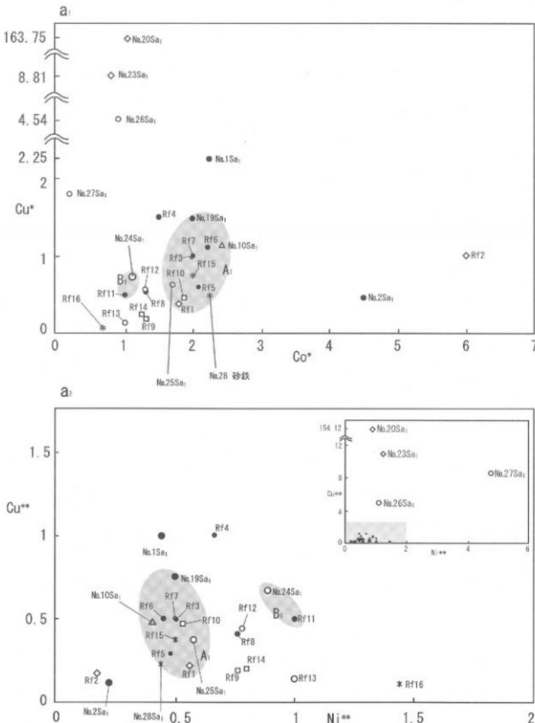
図14 分析した鐵器・鐵塊・鐵塊系資料に含有されるCu・Ni・Co三成分比
