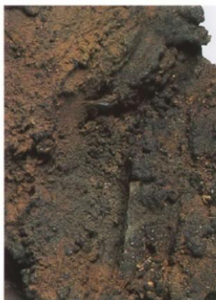
写真28 半還元溶融砂鉄拡大
