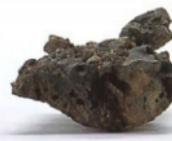
写真30 流状滓（表、断面）
