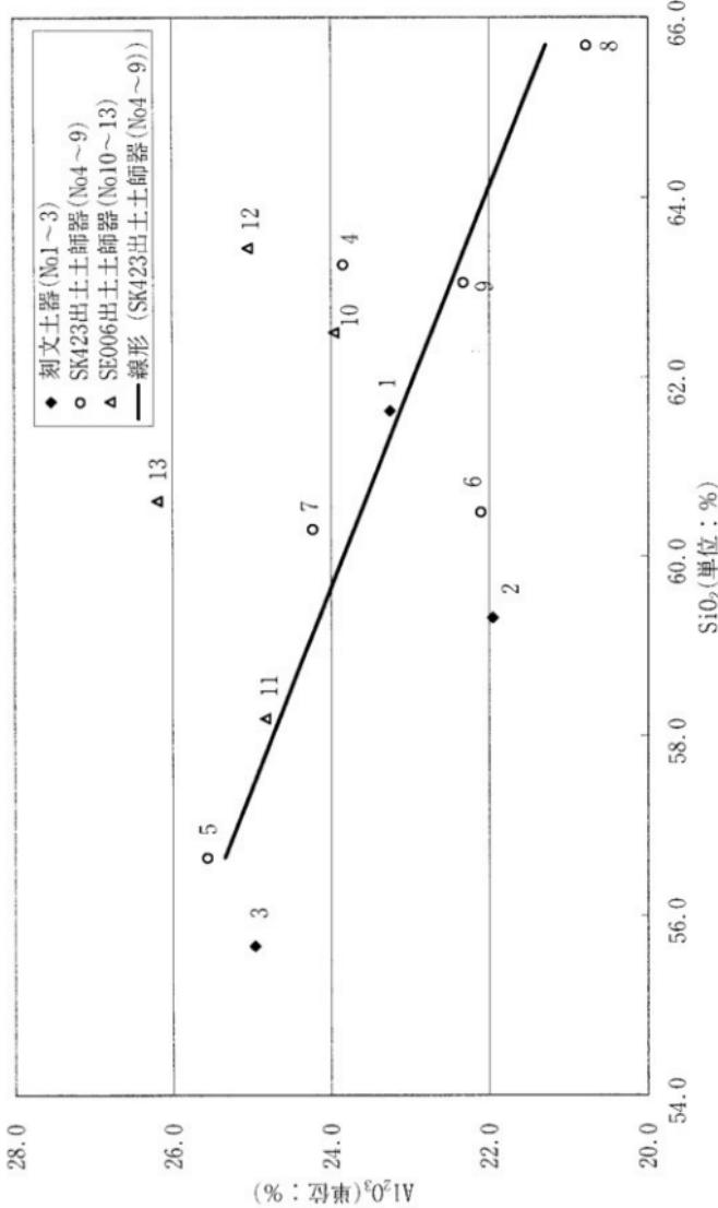
図3 SiO<sub>2</sub>-Al<sub>2</sub>O<sub>3</sub>分布図
