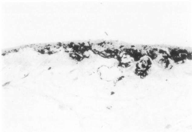
写真 No.1 漆碗内面の塗膜断面(×400)
