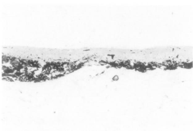
写真 No.3 漆柾外面の塗膜断面( $\times 400$ )
