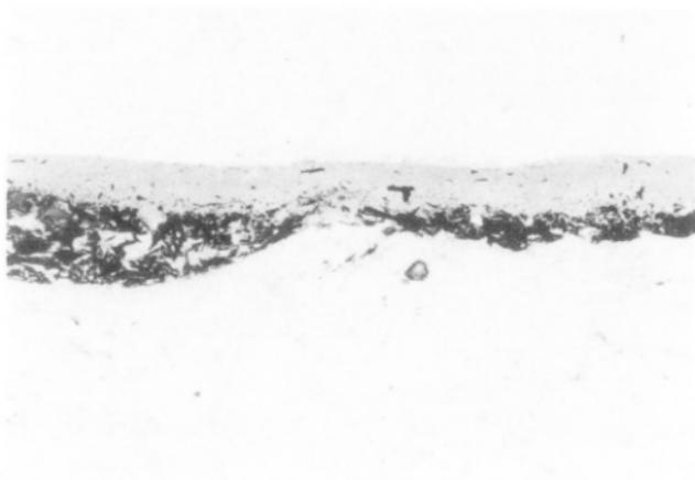
写真 No.3 漆桶外面の塗膜断面(×400)
