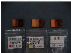
写真7 テストピースへの柿渋塗布実験状況
