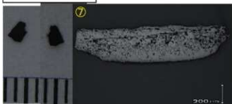
Photo.6 鍛造剥片の顕微鏡組織
