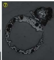
Photo 20 粒状滓の顕微鏡組織
