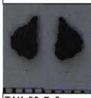
TAK-32-ロ-2 鍛造剥片 ⑦⑧明白色層:ヘマト、灰 褐色層:マグネサイト、灰色層: ウスタイト
