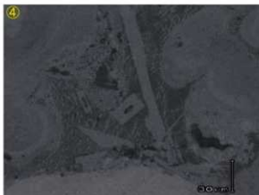
Photo.19 椀形鐵冶滓・鉄塊系遺物の顕微鏡組織
