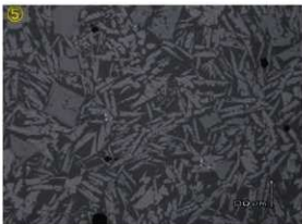
Photo.16 炉壁(砂鉄焼結)・流出溝滓の顕微鏡組織
