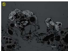
Photo.10 鉄塊系遺物・炉壁の顕微鏡組織・EPMA調査結果
