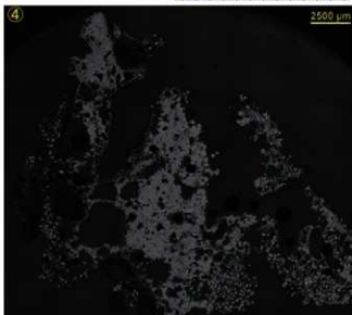
Photo.17 炉壁・炉内流動滓の顕微鏡組織
