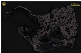
Photo.12 炉底塊・炉内滓の顕微鏡組織
