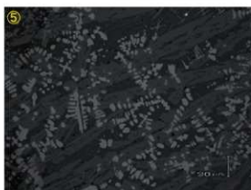
Photo.1 梘形鍛冶滓の顕微鏡組織
