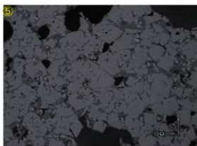
Photo.7 椀形鍛冶滓の顕微鏡組織
