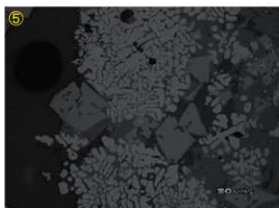
Photo.17 鉄塊系遺物・椀形鍛冶滓の顕微鏡組織
