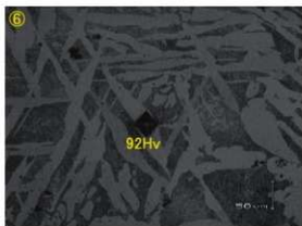
Photo.23 鍛造剥片・梘形鍛冶滓(含鉄)の顕微鏡組織
