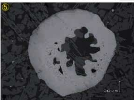
Photo.5 椀形鍛冶滓?の顕微鏡組織
