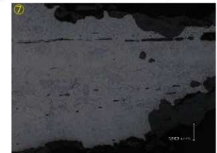
Photo.12 鍛造剥片・鉄製品(手斧)の顕微鏡組織
