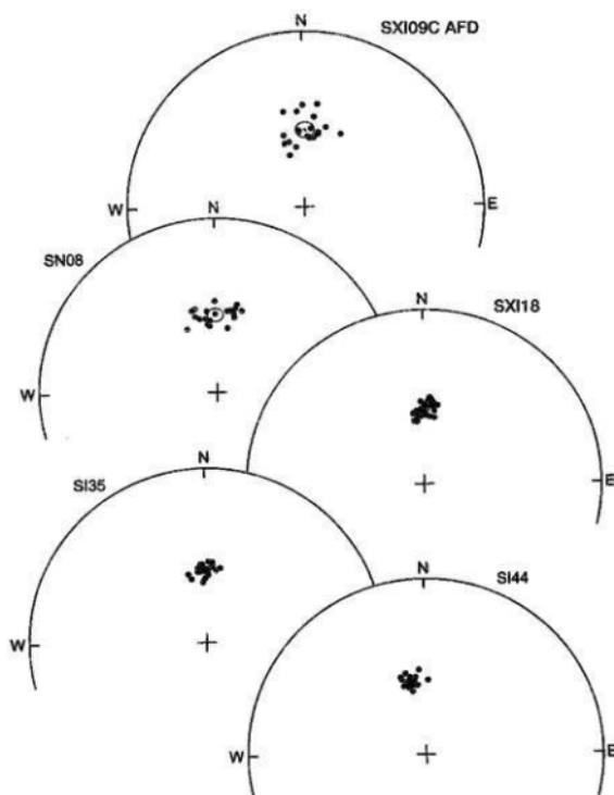
図36 交流消磁後の残留磁化方向分布
