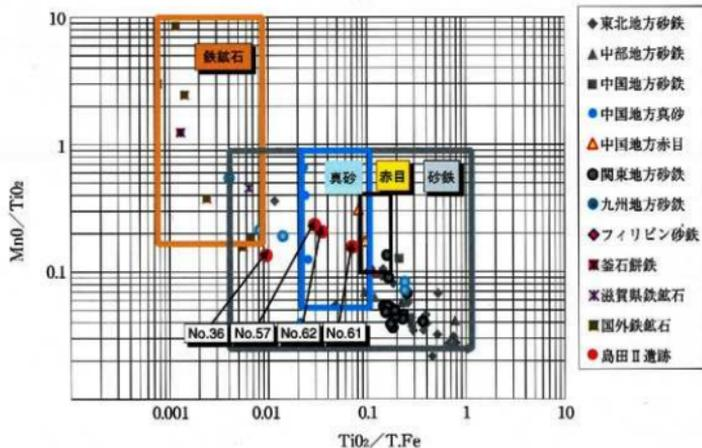
図6 砂鉄原料の酸化チタン (TiO<sub>2</sub>) と酸化マンガン (MnO) との関係
