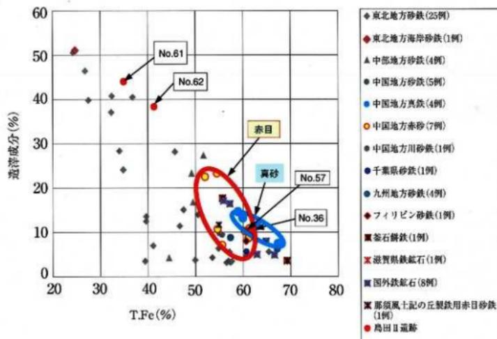
図5 砂鉄中の全鉄量と逸失成分量の分布図
