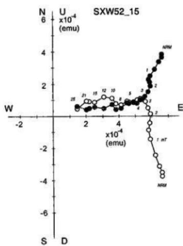
図34 交流消磁によるSXW52試料15の磁化変化
