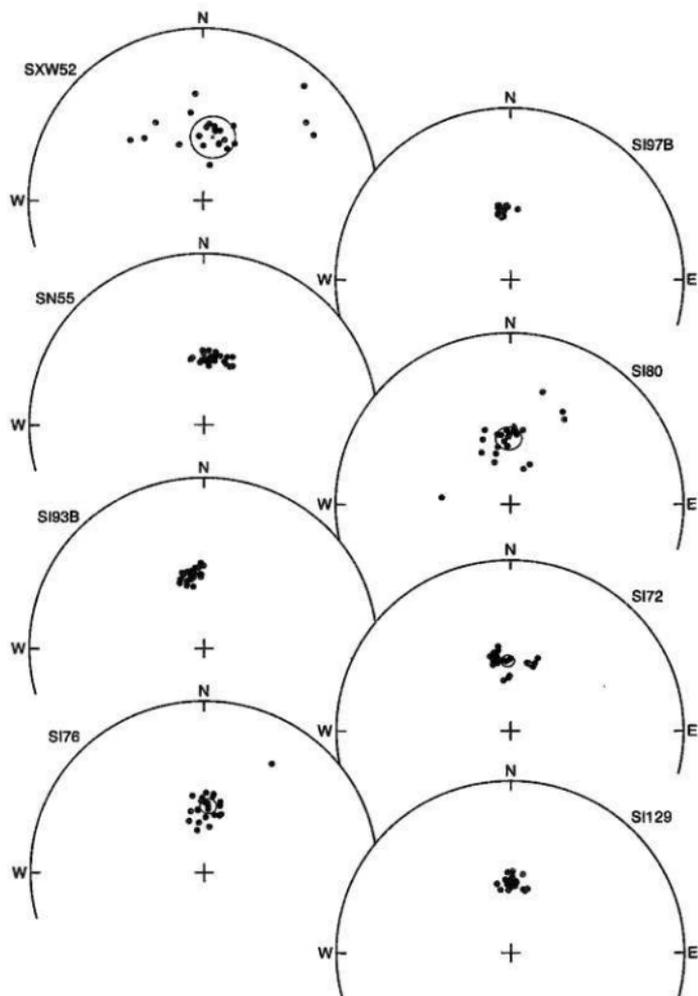
図28 SXW52、SN55、SI93B、SI76、SI129、SI72、SI80、SI97Bの自然残留磁化の投影。黒丸は現在の地球磁場と同じ方向を示す。平均値を×印で示し、95%信頼区間楕円を示してある。
