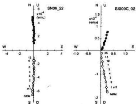
図31 SI44、SX118、SN08、SX109Cの交流消磁結果
