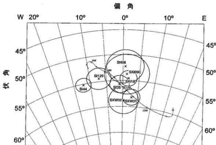
図40 1999年、2000年に測定した試料の残留磁化方向と地磁気永年変化
