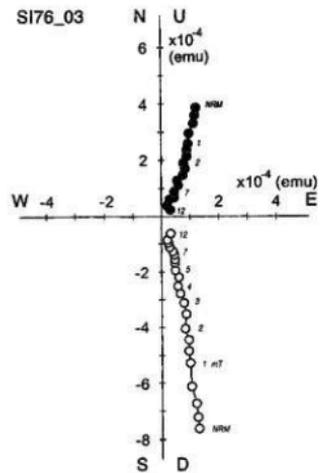
図33 交流消磁によるSI93B試料21、SI76試料03の磁化変化
