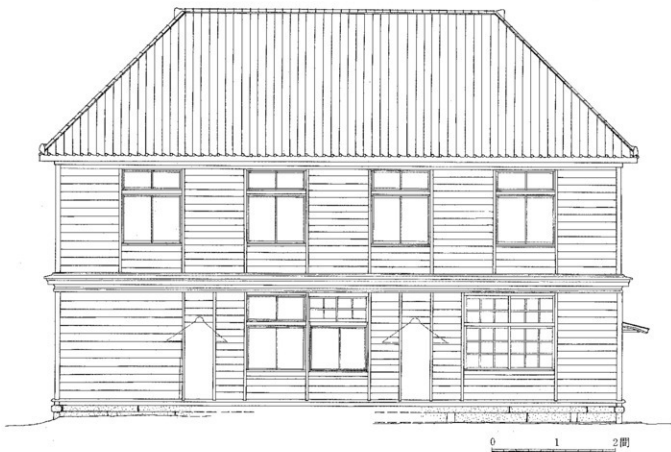
第6図 庁舎外觀実測図1 (上:南面 下:北面) 北面礎石の一部は実測不能のため省略。屋根も後補した。
