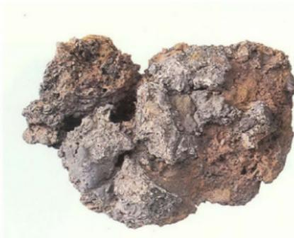
写真16 炉底滓（鉄滓溜り 2 より）
