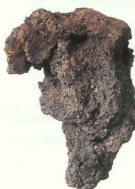
写真11 炉底滓（炉より）
