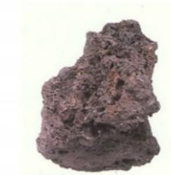
写真17 炉底滓（鉄滓溜り2より）
