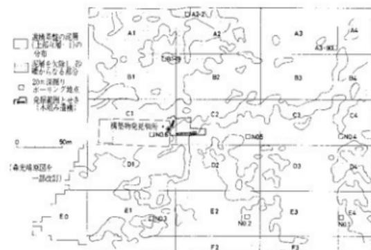
第16図 ボーリングによる地下地質平面図
