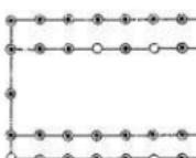
東西棟桁行7間×梁行4間で、南北に廊をもつ掘立柱建物跡である。<sup>(1223)</sup>身舎の柱間平均距離は桁行14.03m(東から2.02+1.94+2+2.01+1.98+2.05+2.03m)、梁行5.49m(北から2.78+2.86m)で、計画尺による桁行46尺(東から6.5+6.5+6.5+6.5+6.5+7+6.5尺)、梁行18尺(9尺等間)である。この身舎に南北に1間(推定7尺)ずつの廊が付いて推定総間は計画尺による桁行46尺、梁行32尺と思われる。1尺は平均30.5cmで
