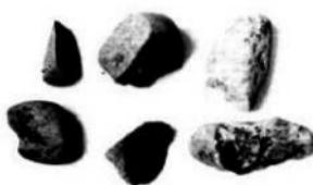
写真1 離層中の新しい割れ口を持つ礫の例
