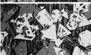
Photo. 22 楕形鍛冶滓の顕微鏡組織
