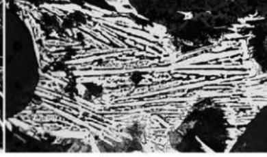
Photo. 17 鉄塊系遺物の顕微鏡組織
