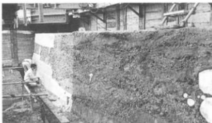
fig. 752 垂水・日向遺跡土層転写（合成樹脂を塗る）
