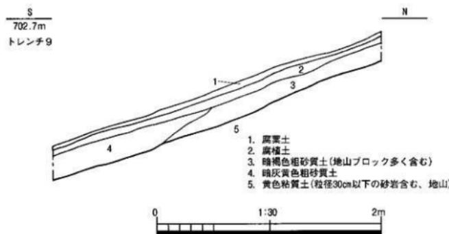
第6図 遊歩道(なか道)敷設箇所トレンチ 土層断面図
