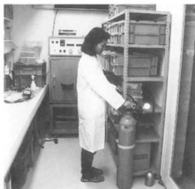
fig.250 繊維付着青銅鏡の窒素ガス封入作業
