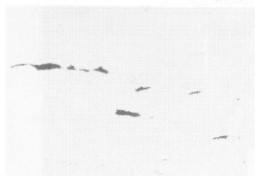
PG 5. 刃先部に多量に見られた非金属介在物
