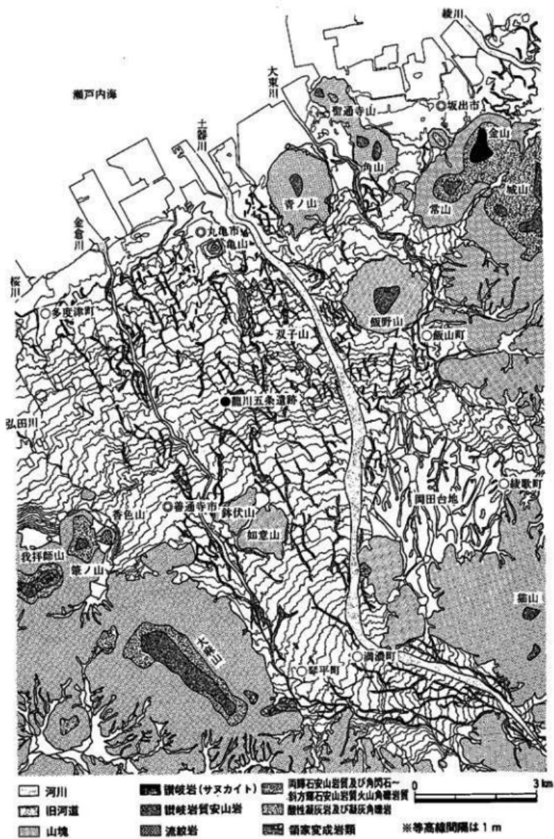
第4図 丸亀平野の地形・地質概要図
