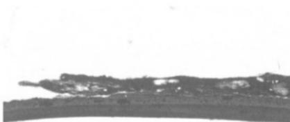
写真25 漆・布断面 (縦糸横断方向) 跳微鏡写真 (70倍)
