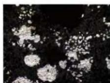
写真108 D-1 塊状金属鉄 (50倍)
