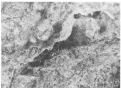
fig. 348 鋳掛部分 2 の X 線透過像
