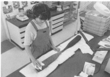
fig. 593 PEG含浸後、アルコールで表面を洗浄する
