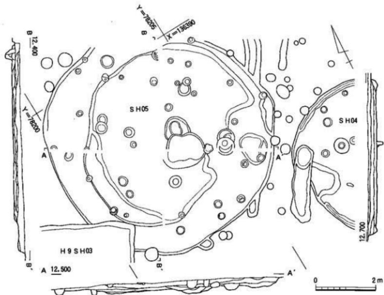
第92図 D 1 a 区第2面SH04・05平・断面図
