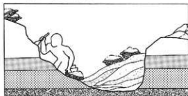
3. 廃土を後方に捨てながらさらに掘り進める。
