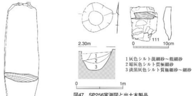
図47 SP256実測図と出土木製品
