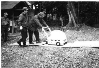
地中レーダー探査風景
