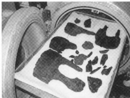
fig. 327 真空凍結乾燥作業
