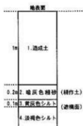
Fig.3 基本土層柱状模式図
