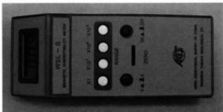
fig. 106 携帯用帯磁率計WSL-B型
