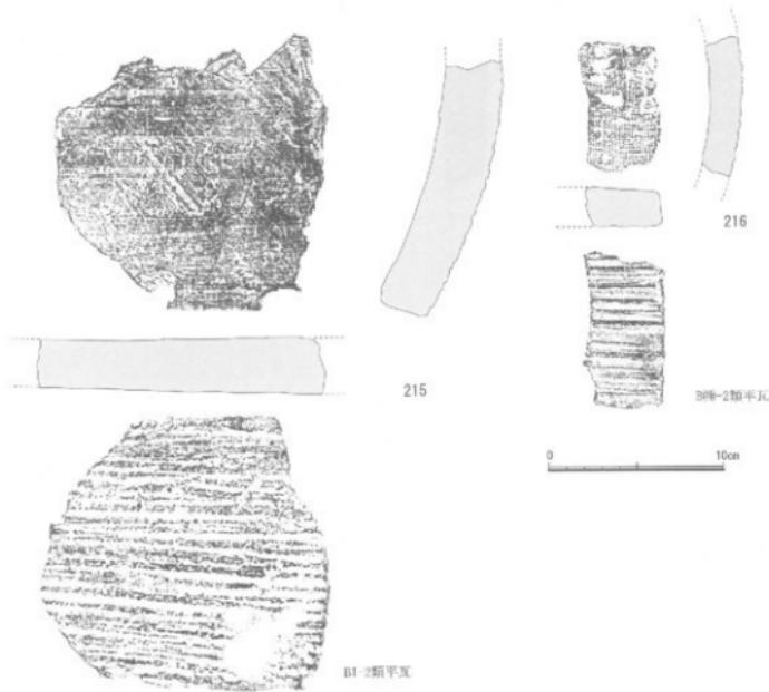
図50 土坑08出土 平瓦拓影および断面図(3) B類 凸面平行叩き(縄目均等)
