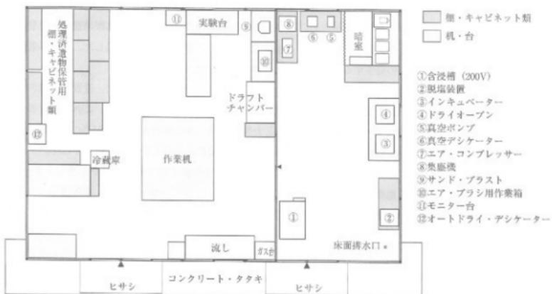
図6 保存処理作業室平面図
