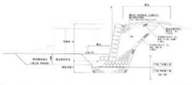
第208図 中門跡石積み工断面図
