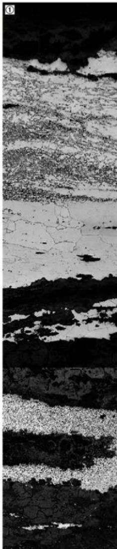
Photo.13 鉄片の顕微鏡組織
