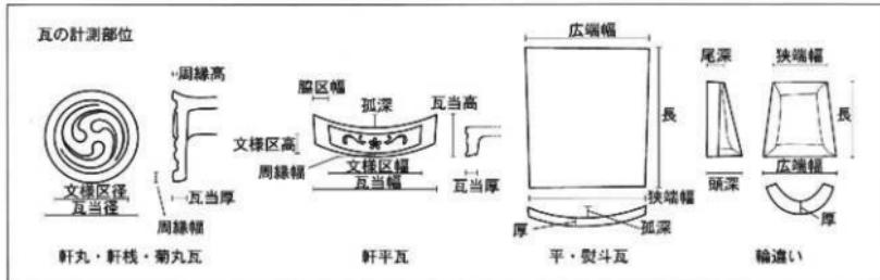
第32図 瓦計測部位模式図
