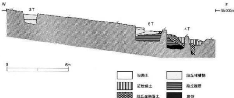
第38図 土塁縞部基本層断面図
