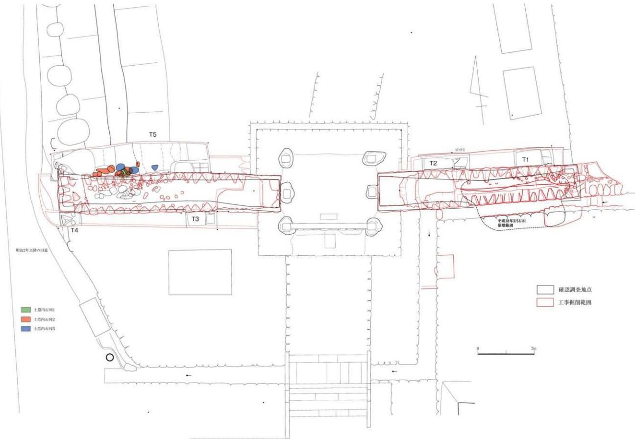
第9図 平成18年度災害復旧工事表門脇石垣解体最終状況平面図
