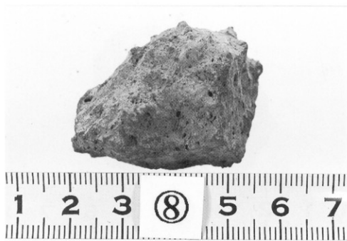
写真 洞ノ口遺跡 鍛冶関連遺物 資料No.⑧-3 鉄滓の外観
