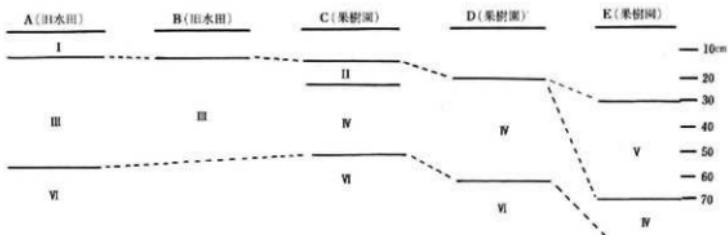
I. 稲作土 II. 灰黃褐色砂質土 III. 黃褐色粘土質 IV. 茶褐色砂質土 V. 黑褐色砂質土(遺物包含層)
