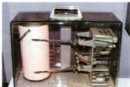
展示ケース内の温湿度測定器（長野県立歴史館常設展示室） 文化財の展示に際しては、光量や温度の調整をし、調湿剤で湿度調節をおこなうなど、資料の保存に配慮が必要である。
