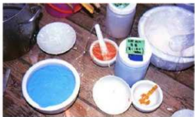
彩色文様修復用の岩絵の具 この建物用に特別調合された粉状の岩絵の具は、お湯に溶いた膠（接着剤）に混ぜて木材の表面に塗る。
