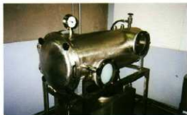
保存処理機器（金属器樹脂含浸装置） 有機溶剤、薬剤、合成樹脂などを効率よく安全に安定して使用できるように設計されている。
