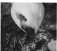
写真18 覆い型野焼き実験土器の外A面の不定形黒斑と筋状酸化
